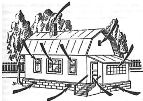
Для повышения герметичности помещений необходимо заделать все трещины и щели в окнах, дверях и дверных коробках, закрыть отдушины, вытяжки, дымоходы, задвижки, при этом целесообразно использовать липкую полимерную ленту. Щели в местах прилегания двери к дверной коробке можно
