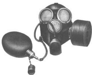
***Гражданский фильтрующий противогаз ГП- 7В (модификация ГП- 7В отличается от базовой модели тем, что имеет устройство для приема воды непосредственно в зоне заражения)***
