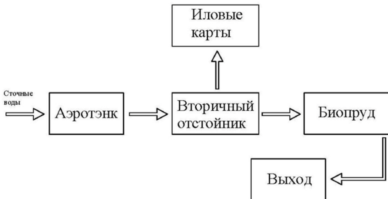
Рисунок 2.1.4– Принципиальная схема очистки сточных вод на КОС пос. Тимирязевский
