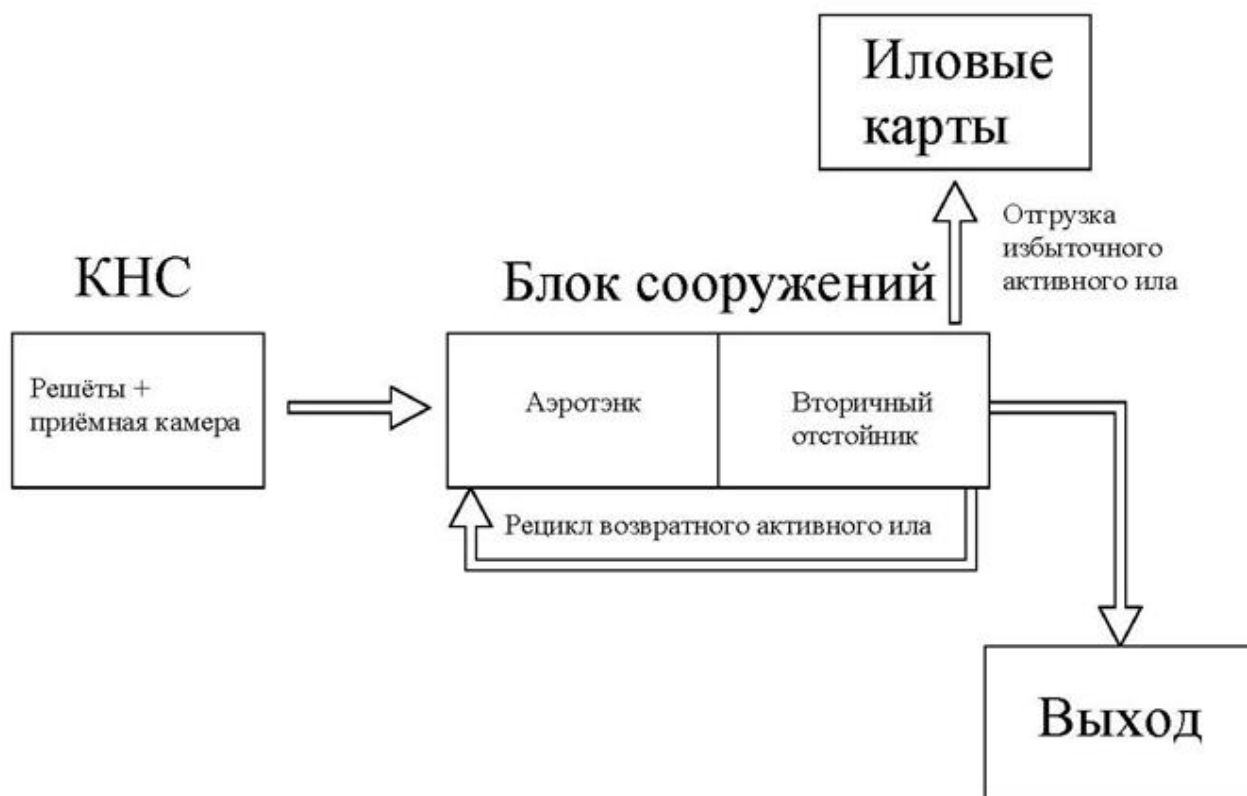
Рисунок 2.1.8– Принципиальная схема очистки сточных вод на КОС с. Степное
